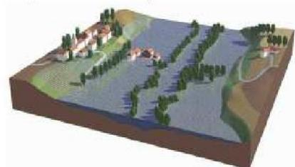
Lorsque le sol est saturé d'eau, **la nappe affleure et inonde les terrains bas**.
